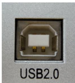
USBケーブルは、USB1.0とUSB2.0の2つの種類があります。物理的な形状はまったく一緒ですが、電気的な特性が異なります。点字プリンタがUSB2.0に対応している場合、USB1.0のケーブルを使用すると通信が不安定になり安定した点字印刷が行えません。基本的にUSB接続をする場合には点字プリンタに付属のUSBケーブルをご使用ください。
