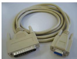
点字プリンタとの接続に使うシリアルケーブルは一般的にはクロスケーブルと呼ばれる結線のものを使います。しかし、点字プリンタの機種によっては特殊な結線のケーブルを必要とするものがあります。シリアルポートを使って点字プリンタを接続する際のトラブルの原因として多いのが、間違った結線のシリアルケーブルを使用することです。基本的にシリアルポートを使って点字プリンタとパソコンを接続する際には、点字プリンタを購入された際に付属されていた動作の保証されたシリアルケーブルをお使いください。
