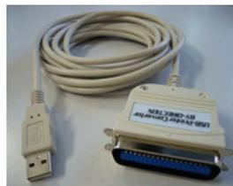
多くのUSB-パラレル変換ケーブルはWindows XPに標準添付のドライバを使用するので、変換ケーブルをパソコンのUSBポートに挿すだけで自動認識され、すぐに利用できるようになります。ただし、USB-パラレル変換ケーブルによっては、特別なドライバをインストールする必要があるかもしれません。この場合には、変換ケーブルの取り扱い説明書の指示に従ってドライバをインストールしてください。
