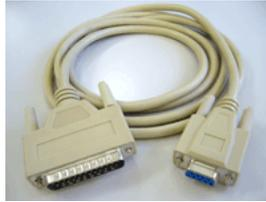
点字プリンタとの接続に使うシリアルケーブルは一般的にはクロスケーブルと呼ばれる結線のものを使います。しかし、点字プリンタの機種によっては特殊な結線のケーブルを必要とするものがあります。シリアルポートを使って点字プリンタを接続する際のトラブルの原因として多いのが、間違った結線のシリアルケーブルを使用することです。基本的にシリアルポートを使って点字プリンタとパソコンを接続する際には、点字プリンタを購入された際に付属されていた動作の保証されたシリアルケーブルをお使いください。
