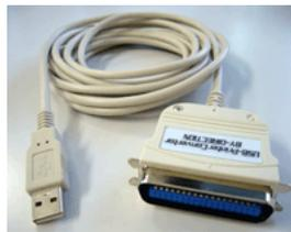
多くの USB-パラレル変換ケーブルは Windows 8 に標準添付のドライバを使用するので、変換ケーブルをパソコンの USB ポートに挿すだけで自動認識され、すぐに利用できるようになります。ただし、USB-パラレル変換ケーブルによっては、特別なドライバをインストールする必要があるかもしれません。この場合には、変換ケーブルの取り扱い説明書の指示に従ってドライバをインストールしてください。
