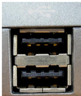
点字プリンタ側の USB ポート端子は、肩が斜めに削れた四角い窪みの形状をしています。内部に金属接点の付いた長方形の突起が入っています。
